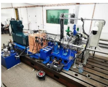
Standul configurat pt testare pompe
