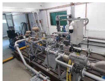
Standul configurat pt testare turbopompe
